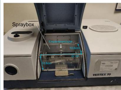
Spectromètre IRTF Vertex 70
