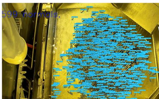
Détection des coques avec YOLO.
