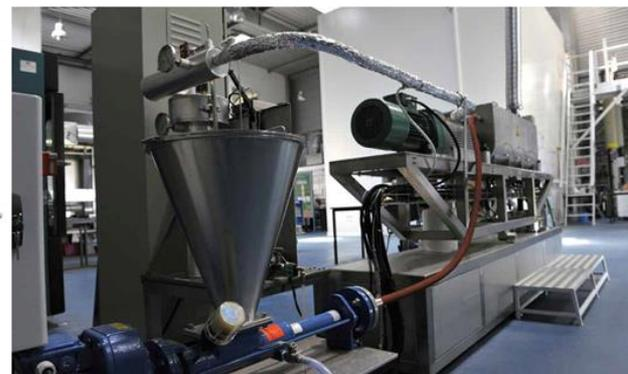
Cristalliseur, tambour tournant froid, four tournant
