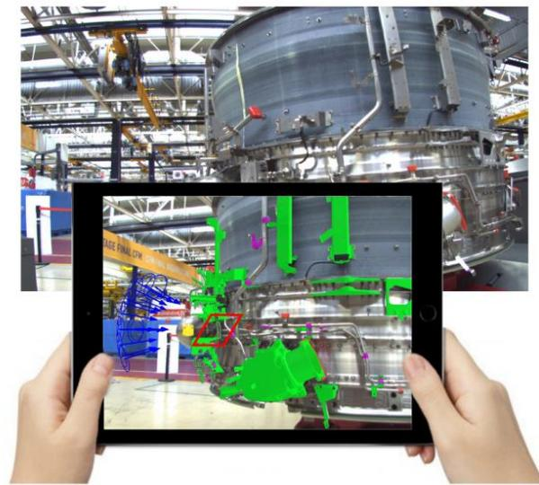
Création d'un outil d'assistance pour l'inspection avec guide de positionnement de l'opérateur : composant à inspecter dans le cadre rouge.
