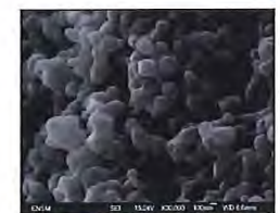
Grains nanométriques obtenus par frittage réactif sous champ micro-ondes ( Al_2O_3-ZnO )
