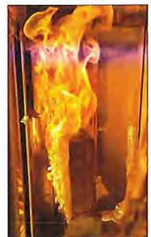
Essai au feu sur un échantillon de PMMA de 70 cm x 70 cm
