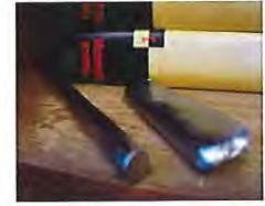
Une barre forgée et un lingot coulé en CoCrFeMnNi. Centre SMS, 2013
