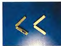
Résilience de l'A3S à froid : forte énergie de rupture à -150° C
