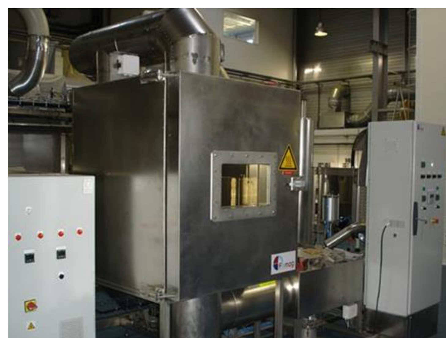
Prototype pour le séchage en vapeur d'eau surchauffée
