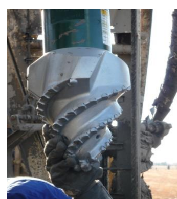
Test sur chantier de forage de l'outil auto-pénétrant (brevet MINES ParisTech)
