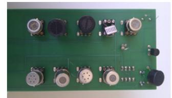
Systèmes multicapteurs (9 gaz + humidité température)
