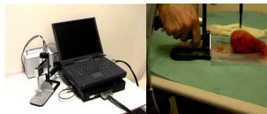
Essai d'indentation d'un utérus à l'aide de la pince Rhéobiol
